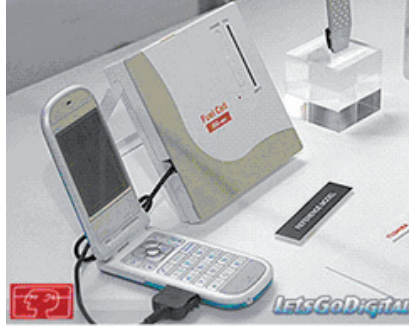
Resim 9: Toshiba'nın yakıt hücresi kullanan cep telefonu ve Nippon firmasının polimer elektrolit yakıt hücresi kullanarak hidrojen gazı ile çalışan ilk prototip cep telefonu.
