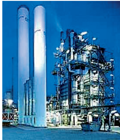
Metan, buhar yardımıyla CO 2 ve H 2 moleküllerine ayrıştırılabilmektedir.
