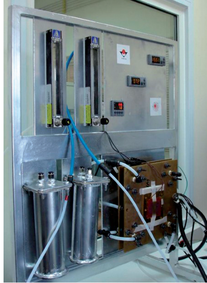
TÜBİTAK MAM Enerji Enstitüsü tarafından üretilen gerçekleştirilen prototip PEM tipi yakıt pili modülü ve test sistemi
